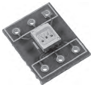
写真1 RGB LED AE-SDEF0500BC1(10×8 mm) SDEF0500BC1(星和電機)搭載、 購入元 秋月電子通商、50円
